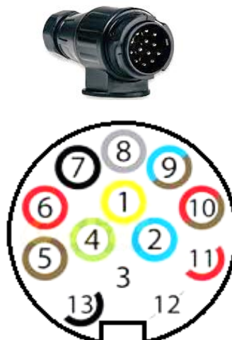
Schemat 2. Schemat instalacji elektrycznej złącze 13- stykowe
